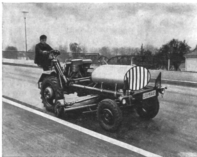
Fig. 1: Le porte-outils automoteur «Alldog» transformé en arroseuse-balayeuse par le montage d'un réservoir à eau et d'une brosse rotative.
