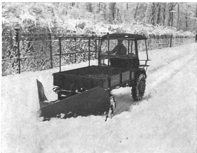
Fig. 3: Le porte-outils automoteur est équipé ici d'un chasse-neige du type étrave et d'un dispositif épandeur de sable ou de gravillon.
