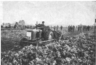
Fig. 3: Vue d'une machine anglaise à récolte complète qui range les racines en andains transversaux. Les feuilles et collets ne sont pas utilisés.
