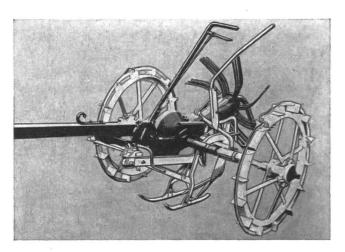
Fig. 2: L'appareil arrache-betteraves «Au», à guidage automotique, vu de plus près. (Il est fixé ici sur l'arracheuse de pommes de terre Lanz.)
