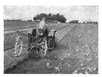
Fig. 1: L'appareil d'arrachage «Au», pour betteraves, se monte sur l'arracheuse de pommes de terre à traction animale (guidage automatique).
