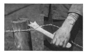
La pince tendeuse «Dresky» facilite grandement la pose de clôtures de fils de fer lisses ou barbelés.
