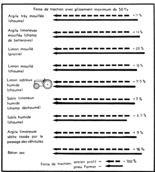
Dans les cas où la totalité de la force de traction n'est pas exigée parce que la résistance à l'avancement est peu importante — lors du labourage, par exemple —, le pneu Farmer montre sa supériorité par un glissement
