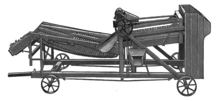
Il est bon de prévoir ces machines dès le début avec moteur électrique adossé. Ces moteurs sont livrables aujourd'hui avec variateur de vitesse permettant d'adapter le mouvement des cribles aux différentes sortes de tubercules.
