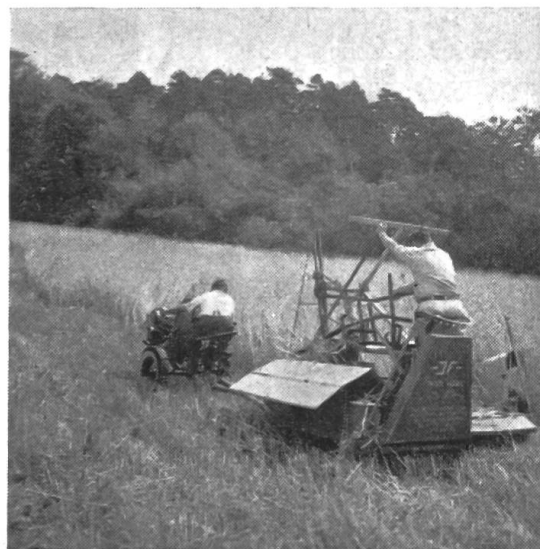
Fig. 14a L'avant-train autohaleur (dit l'«araignée») employé pour la récolte des céréales avec une moissonneuse-lieuse de type léger.
