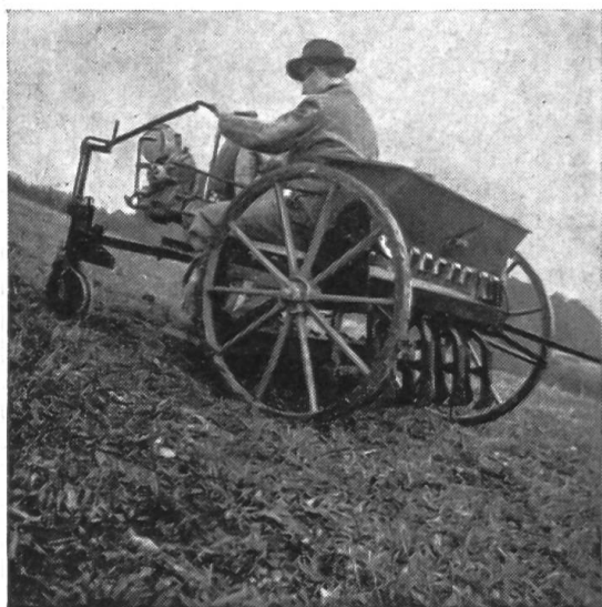
Fig. 12a: Première machine réalisée pour l'emblavage avec la traction funiculaire à un seul desservant. — Elle comprend un semoir à traction animale, un avant-train (équipement de base d'un instrument universel à tracteurs), un treuil du genre cabestan et le moteur.
