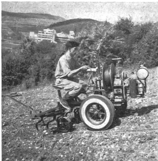
Fig. 10a: Le sarclage exécuté à l'aide de l'avant-train autohaleur et un instrument à deux rangs.
