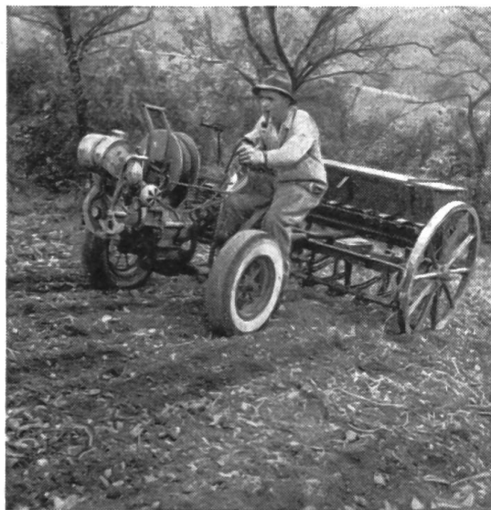
Fig. 12b: Attelage du semoir à traction animale à l'avant-train autohaleur.
