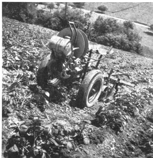
Fig. 10b: Les travaux de sarclage et de buttage effectués en un seul passage.
