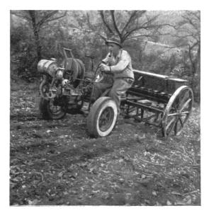
Fig. 12b: Attelage du semoir à traction animale à l'avant-train autohaleur.
