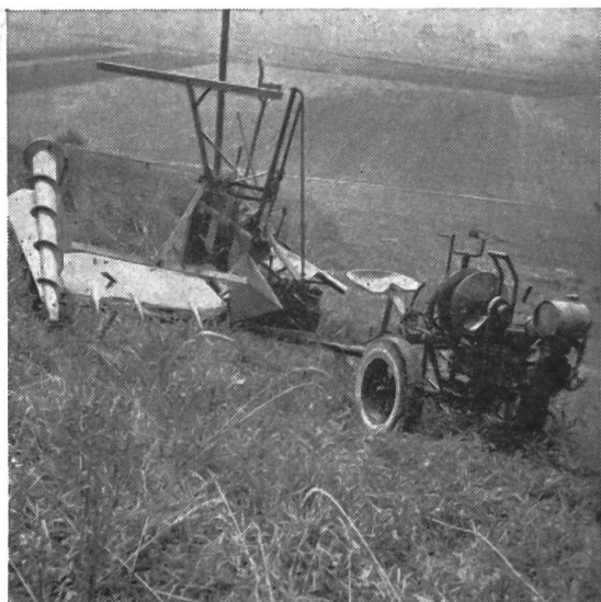
Fig. 14a L'avant-train autohaleur (dit l'«araignée») employé pour la récolte des céréales avec une moissonneuse-lieuse de type léger.
