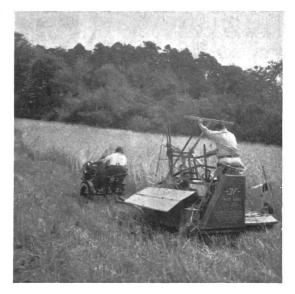
Fig. 14a L'avant-train autohaleur (dit l'«araignée») employé pour la récolte des Fig. 14b céréales avec une moissonneuse-lieuse de type léger.
