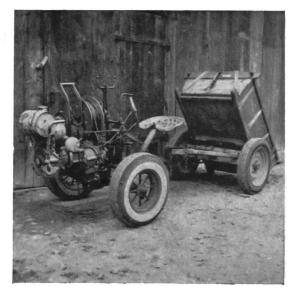
Fig. 15a Remorque à benne basculante accrochée à l'avant-train autohaleur
