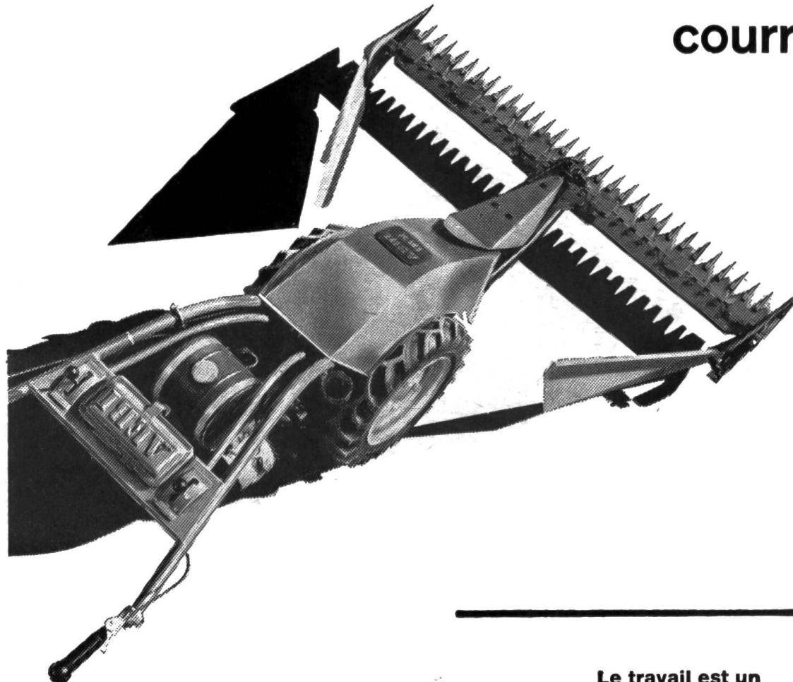
Elles absorbent le choc lorsqu'une pierre se prend dans la barre. C'est le système le plus sûr pour protéger doigts et sections contre la rupture.
