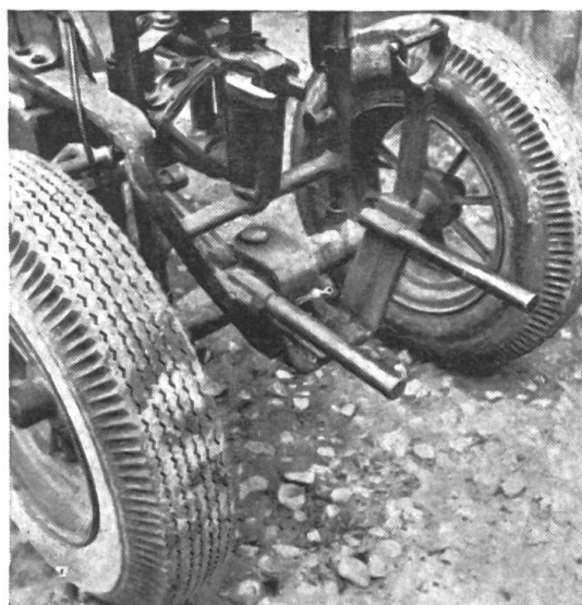
Fig. 4: Barreaux supports destinés au montage frontal du treuil du genre cabestan.
