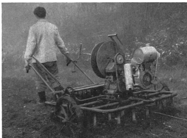
Fig. 8: Herse de montagne (à roues et mancherons) sur laquelle ont été installés le moteur et le treuil du type cabestan.
