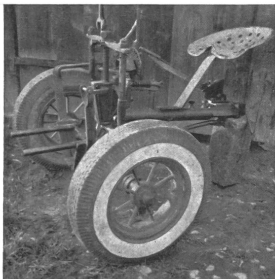
Fig. 3: Vue de l'avant-train sans son moteur et sans son treuil du type cabestan.
