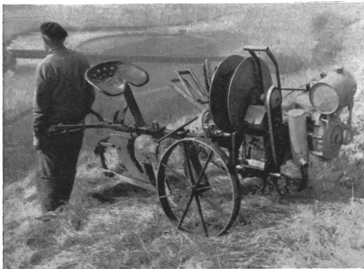
Fig. 1: La première machine réalisée pour la traction par câble avec un seul homme de service.
