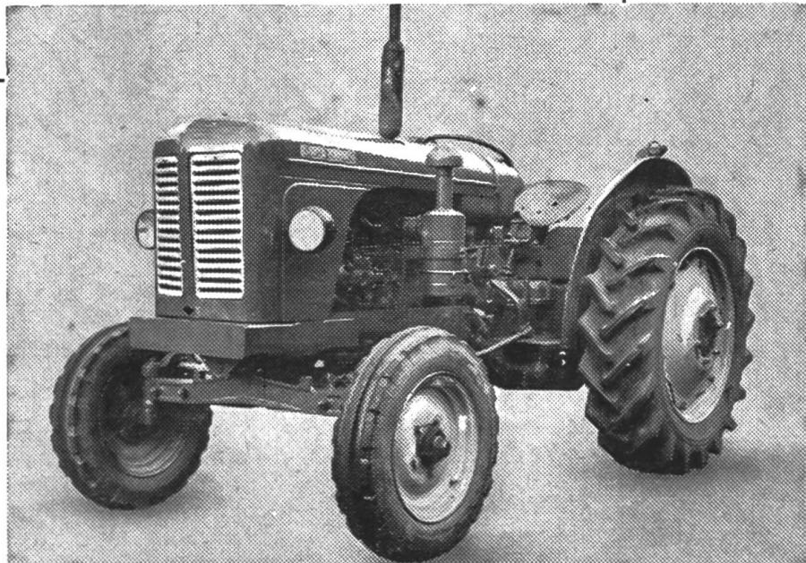
Non seulement les tracteurs Diesel 40 CV. sont des machines adaptables à tous les travaux, mais ils sont tous équipés du T.C.U. du relevage hydraulique, de la prise de force indépendante et du compteur d'heures.
