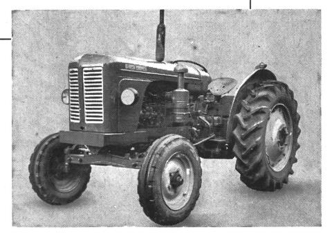
Non seulement les tracteurs Diesel 40 CV, sont des machines adaptables à tous les travaux, mais ils sont tous équipés du T.C.U. du relevage hydraulique, de la prise de force indépendante et du compteur d'heures.
