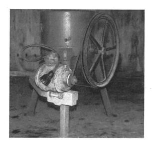
un moteur sur mon coupe-racines. Etant donné que cette machine est utilisée au moins 150 fois par an dans notre exploitation, le moteur facilite considérablement le travail du vacher, qui est très occupé. Puisque le coupe-racines est toujours employé au même endroit, j'ai fait poser une conduite d'amenée de courant offrant toutes garanties de sécurité. Comme il est possible de le voir sur la photo, le câble électrique n'a que 1 m de long.
