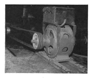
rotation reste donc égale. Elle est d'environ 1400 tr/mn, dans le cas particulier. En installant le moteur, il faut évidemment faire attention à ce que les poulies soient bien alignées, sinon l'usure serait trop grande. Les courroies trapézoïdales représentées ici ont l'air d'être presque neuves bien qu'elles servent depuis 3 ans déjà.
