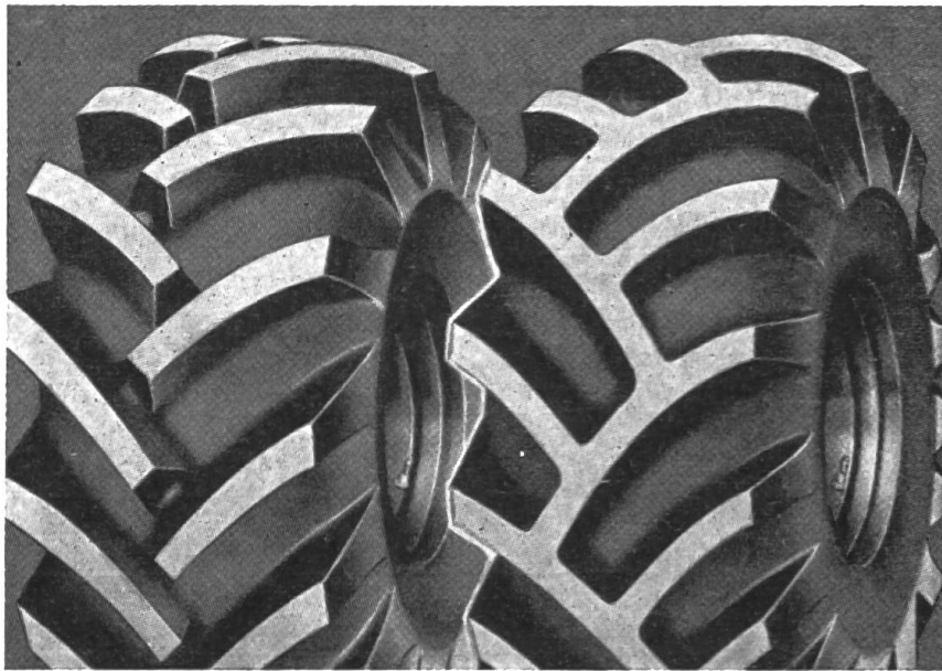
Fig. 12: Pneus Firestone à centre ouvert (open center) et à centre fermé (traction center).
