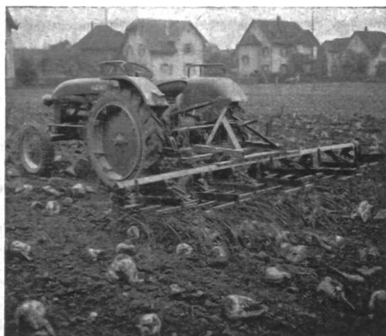
Fig. 3: Nettoyage des betteraves à l'aide de la herse-étrille après leur déterrage.
