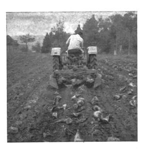
Fig. 2: Déterrage simultané de trois lignes de betteraves au moyen de l'arracheuse-aligneuse à cribles secoueurs.
