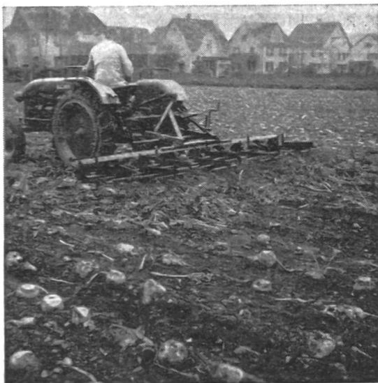
Fig. 1: Nettoyage des betteraves au moyen de la herse-étrille après l'évacuation des feuilles et des collets.
