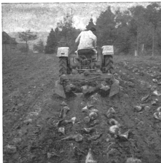
Fig. 2: Déterrage simultané de trois lignes de betteraves au moyen de l'arracheuse-aligieuse à cribles secoueurs.
