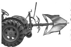
en une charrue portée à déclencheur de sécurité automatique incorporé. S'adapte à tous les tracteurs équipés du dispositif de relevage hydraulique avec système d'attelage en trois points normalisé.
