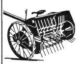
Pour traction par tracteur ou pour traction animale, pour commande par la prise de force, par moteur auxiliaire ou par les roues motrices, Agrar vous livre l'épandeuse d'herbe correspondante.
