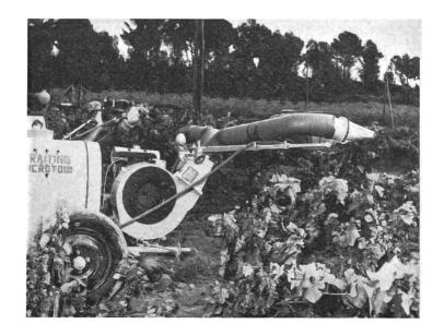
Une décavaillonneuse totalement automatique à commande hydraulique a bien fonctionné.
