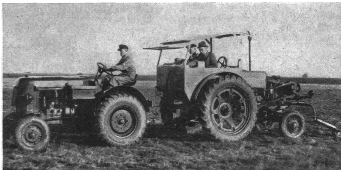
Fig. 1: Mesurage de l'effort de traction et du glissement à l'Institut allemand de recherches et d'expérimentations en matière de machinisme agricole de Braunschweig-Völkenrode. A gauche: tracteur équipé des pneus arrière à essayer. — A droite: véhicule spécial équipé de freins et d'instruments de mesure (véhicule enregistreur).
