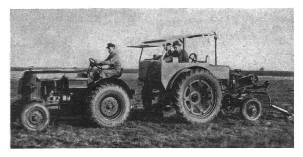
Fig. 1: Mesurage de l'effort de traction et du glissement à l'Institut allemand de recherches et d'expérimentations en matière de machinisme agricole de Braunschweig-Völkenrode. A gauche: tracteur équipé des pneus arrière à essayer. — A droite: véhicule spécial équipé de freins et d'instruments de mesure (véhicule enregistreur).
