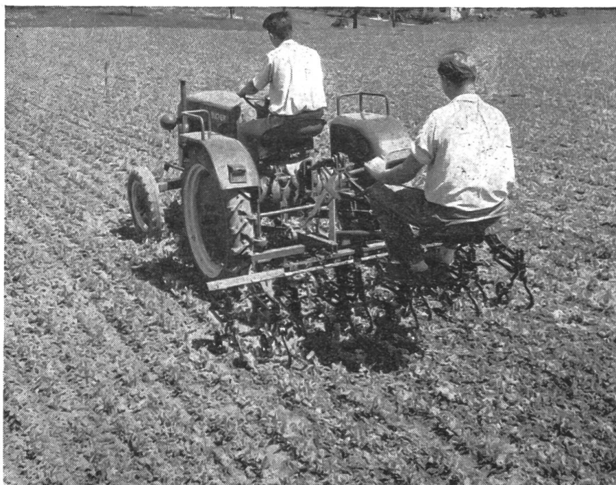
Fig. 3: Instrument uni- versel à système de direction individuel, accouplé à tracteur à usages multiples.
