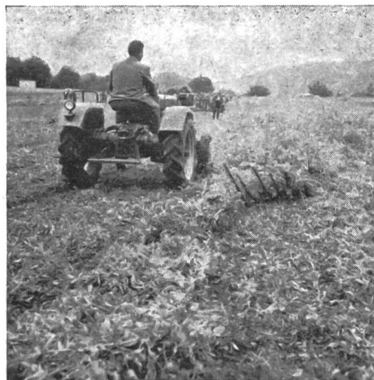
Fig. 9: Dispositif andaineur à tringles d'acier fixes.
