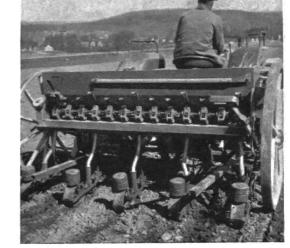
Fig. 6: Semoir porté comprenant des roulettes plombeuses à surface de roulement concave et qui sont équipées de masses d'alourdissement.
