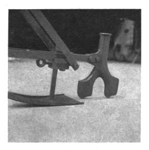
Fig. 4b: Coutre d'enterrage double avec patin assurant une profondeur de travail invariable.
