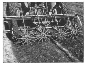
Fig. 7: Instruments servant au prédémariage a) La bineuse-désherbeuse Rémy.
