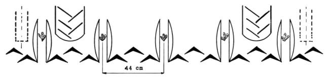
Fig. 5: Avec une voie de 130 cm pour les roues du tracteur (plus exactement dit: 132 cm) et des interlignes de 44 cm, les coutres d'enterrage extrêmes arrivent à se trouver juste entre les roues du tracteur et celles du semoir.
