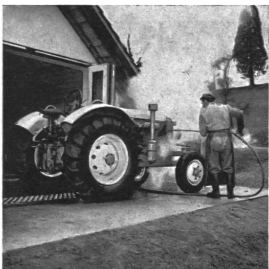
Fig. 4: L'emplacement extérieur de lavage, aménagé sur le devant de la STAMA. On distingue la grille d'écoulement pour la boue.
