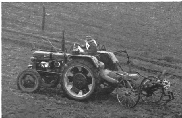
Fig. 3: Les parties de vêtements des personnes se tenant à l'arrière du tracteur peuvent être facilement happées par une prise de force dépourvue de dispositif protecteur et ces dernières être alors gravement mutilées. Le mannequin de paille que l'on aperçoit sur cette photo vient justement de subir ce triste sort.
