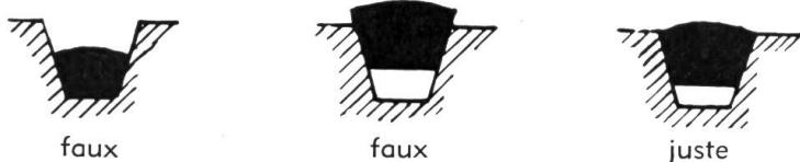
Fig. 5b: La courroie trapézoïdale ne doit pas reposer sur le fond de la gorge de la poulie et ne pas dépasser non plus les bords de la gorge. Il faut que la face supérieure de la courroie se trouve au niveau des bords. — En remplaçant une courroie trapézoïdale, on veillera à la choisir de la largeur et de la longueur appropriée.
