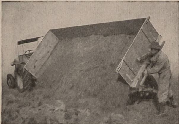
Char à pneus «WM» à pont basculant sur les 2 côtés. Convient tout spécialement pour la traction motorisée.
