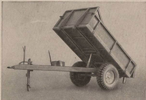
Remorque tous usages à benne basculante, d'une contenance de 1,5 m 3 . Transformable en fourragère en rabattant les panneaux avant et arrière.
