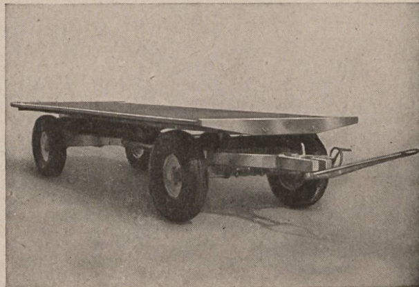
Char à pneus «WM», d'une capacité de charge de 1,5 à 5 tonnes. - Construction entièrement métallique, inoxydable.
