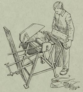
Fig. 6a: Scie circulaire combinée, à table et à chevalet basculants, permettant de scier en long et en travers. Elle est utilisée ici pour la préparation de bois de feu.
