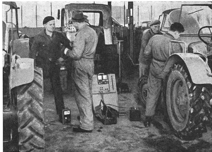
Fig. 5: Vérification de l'équipement électrique avec un appareil de contrôle combiné.
