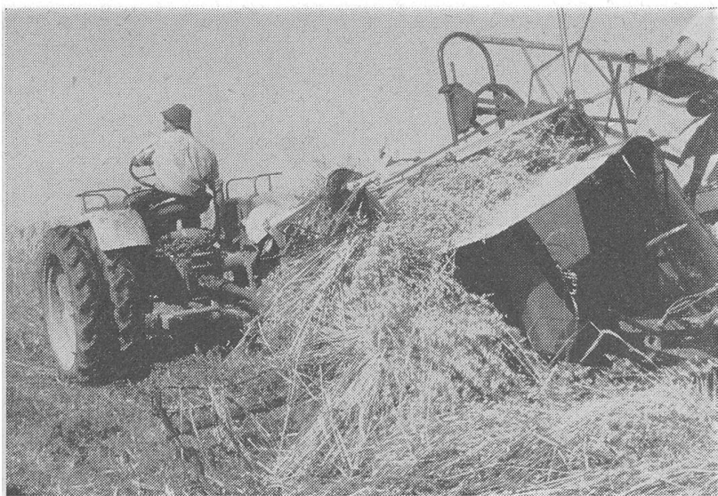
Fig. 3: Tracteur à pneu arrière jumelés accouplé à une moissonneuse-lieuse (largeur de coupe: 210 cm).
