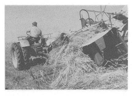
Fig. 3: Tracteur à pneu arrière jumelés accouplé à une moisonneuse-lieuse (largeur de coupe: 210 cm).
