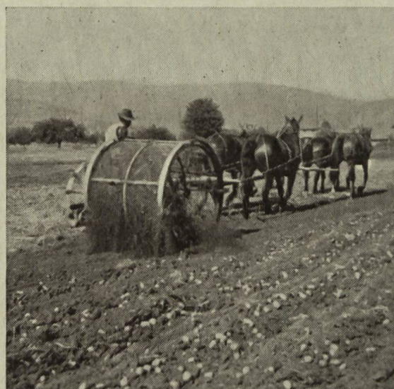
Fig. 3b: Tambour cribleur cylindrique, déposant les tubercules à l'extérieur (côté opposé à celui de la machine).
