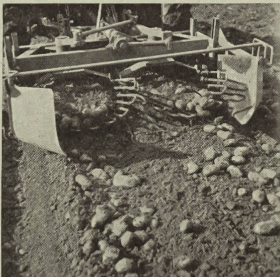
Fig. 12a: Arracheuse-aligneuse à cribles secoueurs, pour deux lignes.
