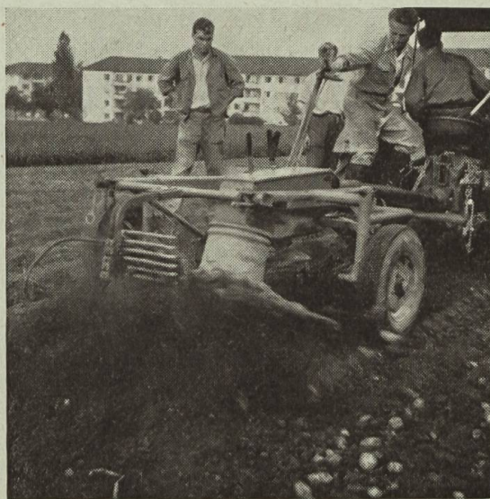
Fig. 11: Arracheuse-aligieuse à grilles rotatives comportant une grille principale ainsi que deux autres grilles auxiliaires, disposées devant elle, qui effectuent un criblage préliminaire.
