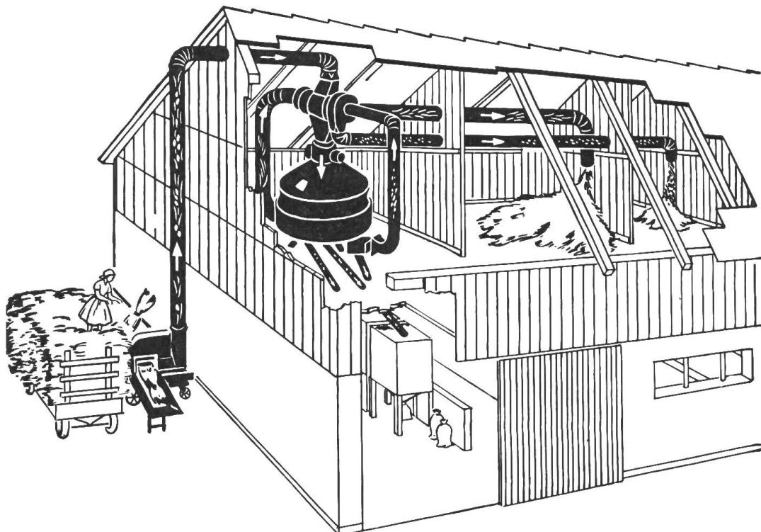
de stockage. Dès le moment où les gerbes sont jetées dans la hacheuse-ensileuse, toutes les opérations se déroulent de façon automatique, soit mécaniquement, soit pneumatiquement.
