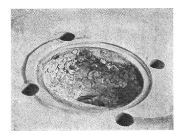
Fig. 2: Forts dépôts de résidus de combustion à l'intérieur de la culasse d'un moteur à 2 temps de 98 cmc de cylindrée.
