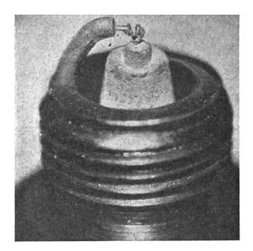
Fig. 4: Formation d'un pont après un trajet de 40 km, à une bougie comportant des électrodes de 0,5 mm de section, en alliage de platine.
