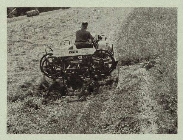
Fig. 12a: Fauchage et épandage exécutés en un seul passage.
