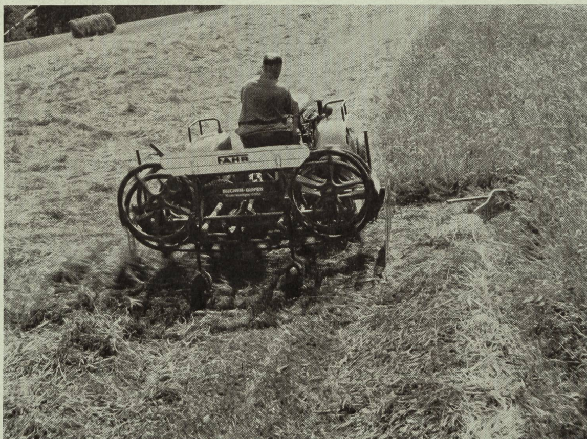
Fig. 12a: Fauchage et épandage exécutés en un seul passage.
