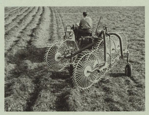
Fig. 5c: Disposition en deux groupes des disques à dents pour le façonnage simultané de deux petits andains et pour leur retournement ultérieur éventuel.
