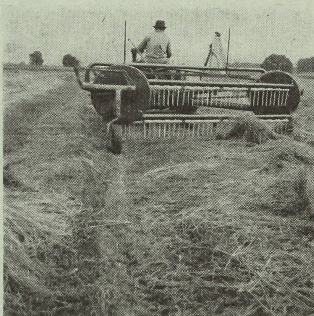
Fig. 4c: Râteau andaineur oblique combiné comportant des peignes à éléments relevables et prévu pour prise de force, vu lors du fanage.
