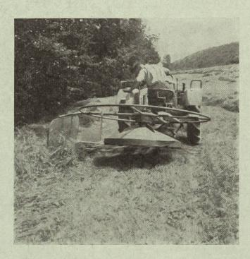
Fig. 10: Machine de fanage à disque horizontal rotatif.
