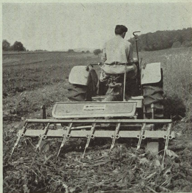
Fig. 2d: Machine d'épandage à dents animées de mouvements alternatifs.
