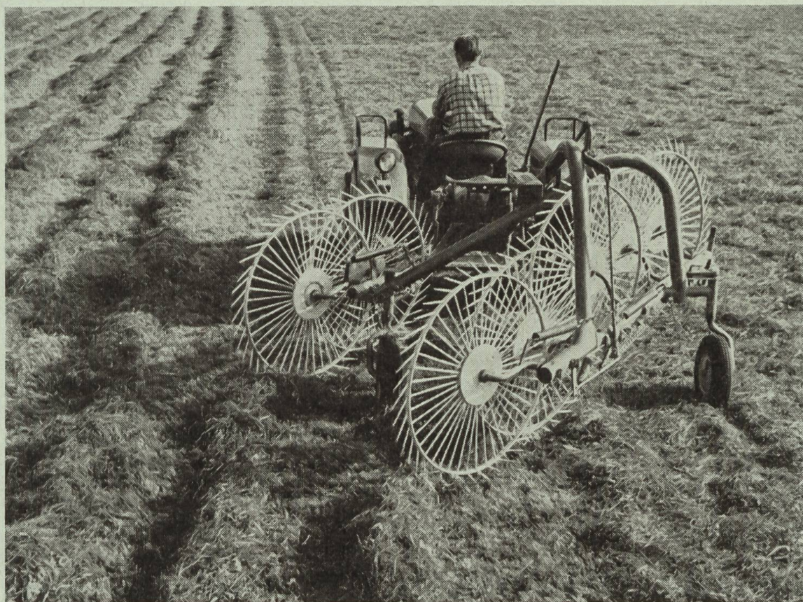
Fig. 5c: Disposition en deux groupes des disques à dents pour le façonnage simultané de deux petits andains et pour leur retournement ultérieur éventuel.
