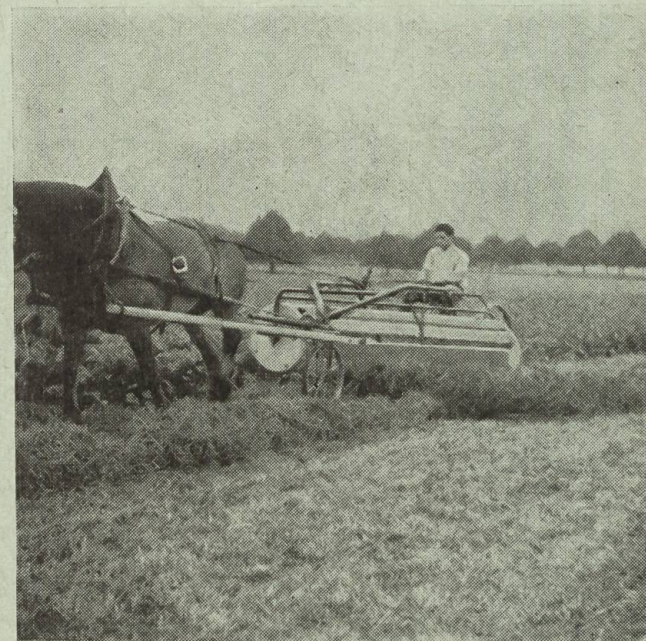
Fig. 4d: Râteau andaineur oblique combiné avec siège du conducteur aménagé derrière les pièces travaillantes (peignes), vu lors de l'andainage.
