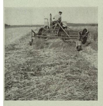
Fig. 8: Râteau faneur à tambour, actionné par prise de force, vu lors de l'épandage des andains d'herbe.
