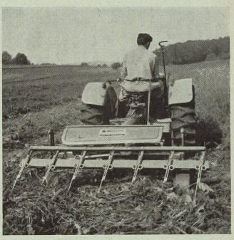
Fig. 2d: Machine d'épandage à dents animées de mouvements alternatifs.
