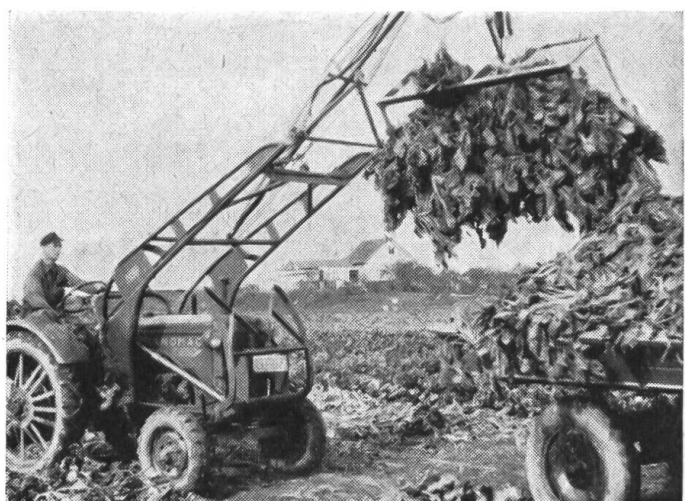
Fig. 2: Chargement des feuilles et collets (rangés en andains transversaux) à l'aide d'un chargeur frontal.
