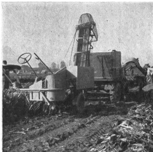
Fig. 10a: La récolteuse Kleine à 1 ligne, avec dispositif décolleteur accouplé devant la machine motrice (Unimog). Les betteraves arrachées sont déversées par un élévateur dans le caisson de l'Unimog, lequel est vidé en bout de raie par basculement. Les feuilles et les collets, disposés en andains longitudinaux, sont chargés par une chargeuse. On peut aussi les charger sur un char tracté roulant en parallèle.
