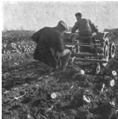
Fig. 4: Arracheuse ordinaire montée sur l'équipement de base d'un instrument universel porté.
