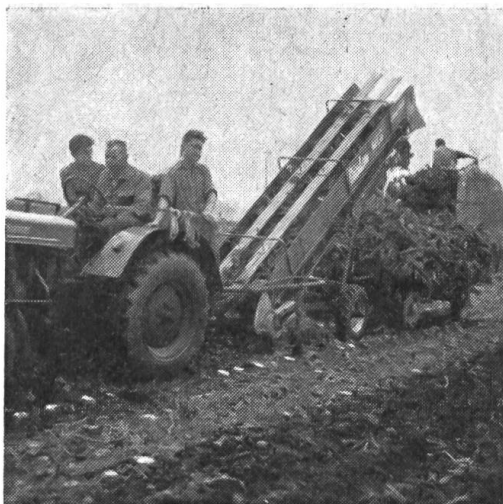
Fig. 3: Chargement des feuilles et collets (rangés en andains longitudinaux) effectué par une chargeuse.
