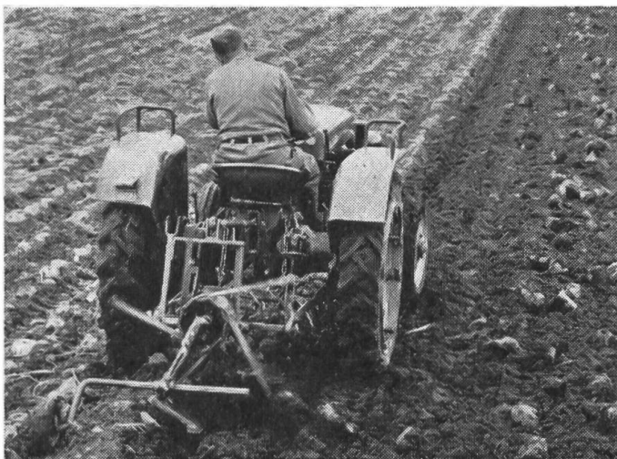
Fig. 5: Arracheuse rotative portée à fourches (arracheuse à pommes de terre équipée de bidents arrache-betteraves).
