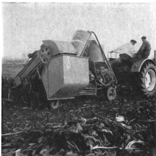
Fig. 7a et 7b: Arracheuses-aligieuses Schmotzer et Stoll à récipient collecteur. Les betteraves et les feuilles sont déposées simultanément et séparément en andains transversaux.
