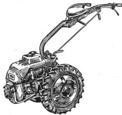
**AGRIA - Universal type 1700, 6/7 CV**, avec boîte à 6 vitesses, 2 prises de force, chaque roue avec freins à tambour, débrayage indépendant des roues motrices, 4 largeurs de voie. Prix: avec roues à pneus 4,50 x 14 AS et moyeux à gradins **Fr. 2,430.—**
