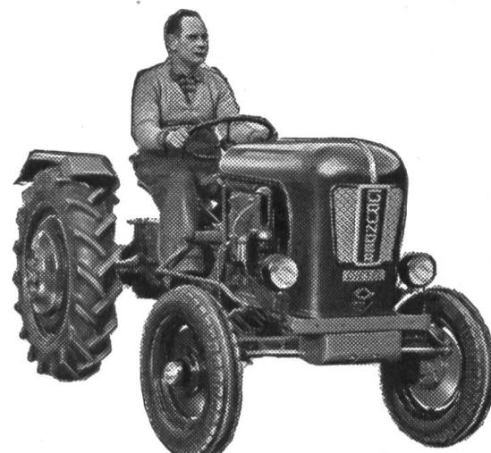
Pionier-3, machine à usages multiples: pour faucher, tirer, travaux au treuil; équipée d'un différentiel avec blocage. Pionier-V monoaxe/motofaucheuse avec dispositif de réglage des axes, différentiel et blocage. Travail de tirage extraordinaire avec remorque tractée. Combinable avec treuil, etc.
