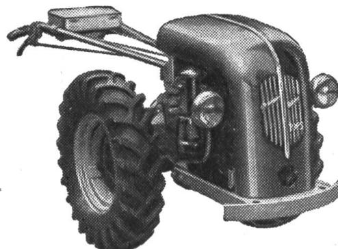
Tracteur agricole GRUNDER TK 15 à 4 roues; moteur Diesel ou benzine; 4 vitesses ou 8 vitesses avant (vitesse rampante); remorque tractée; divers accessoires avec relevage mécanique ou avec relevage hydraulique; charrue portée, herse-rotative 1,40 m, fraise 1,40 m, instruments universels, faucheuse, treuil, poulie stationnaire, etc.
