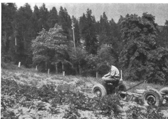
La substructure du char automoteur est utilisée comme porte-outils pour le buttage des pommes de terre sur un champ en pente.
