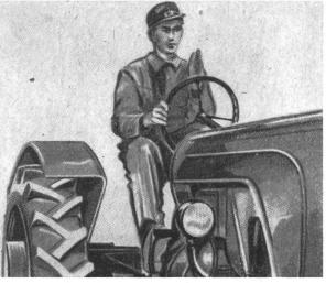
L'entretien des pneus. Un pneu ayant une pression de gonflage conforme aux prescription et aux exigences du service durera plus longtemps. On aura soin de nettoyer de temps à autre l'intérieur de l'enveloppe des pneumatiques et de dérouiller les jantes.
