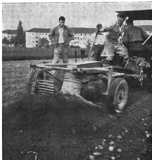
Fig. 4: L'arracheuse-aligneuse Kromag, à grille rotative, actionnée par prise de force
