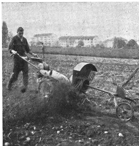
Fig. 2: L'arracheuse-aligieuse Bucher, à fourches rotatives, accouplée à un tracteur Bucher à un essieu
