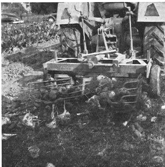
Fig. 9: Tracteur avec l'arracheuse Burekönig 2 rangs, à grilles secouées, pour prise de force
