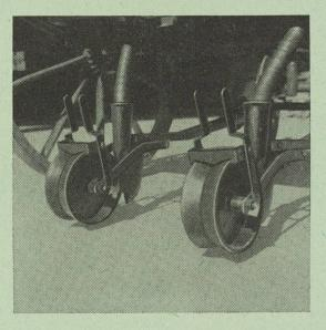
Fig. 4: Roulettes plombeuses à surface de roulement concave pouvues de racloirs et de supports pour des poids alourdisseurs.
