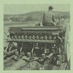
Fig. 7a: Avec une voie du tracteur de 130 cm (132 cm, plus exactement) et des interlignes de 44 cm, les coutres d'enterrage extérieurs se trouvent disposés juste entre les traces des roues du tracteur et celles des roues du semoir.
