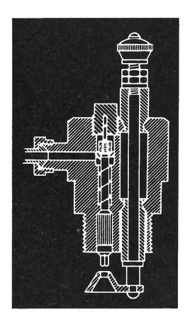
Fig. 1: Ce dispositif (carburateur avec pompe d'injection) a été conçu par Beard autour de 1905. Une came entraînée par le moteur agissait sur une tige de poussoir maintenue par un ressort. Lorsque le piston du moteur commençait sa course d'aspiration, la soupape à ressort obturant la chambre de carburation s'abaissait sous l'effet de la tige de poussoir, permettant ainsi à l'essence retenue par une bille d'arrêt d'être aspirée et pulvérisée dans la chambre de carburation.
