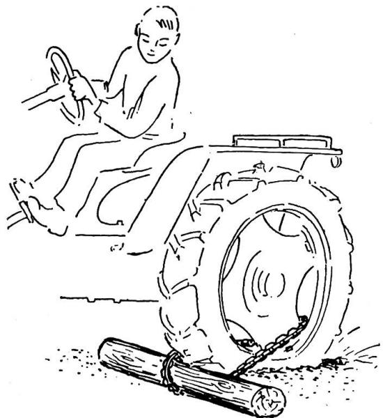
que le rondin ne vienne pas se coincer entre le pneu et le garde-boue. Si le tracteur n'a pas de flasques ajourés, il est indiqué de faire souder des brides des deux côtés de la jante.
