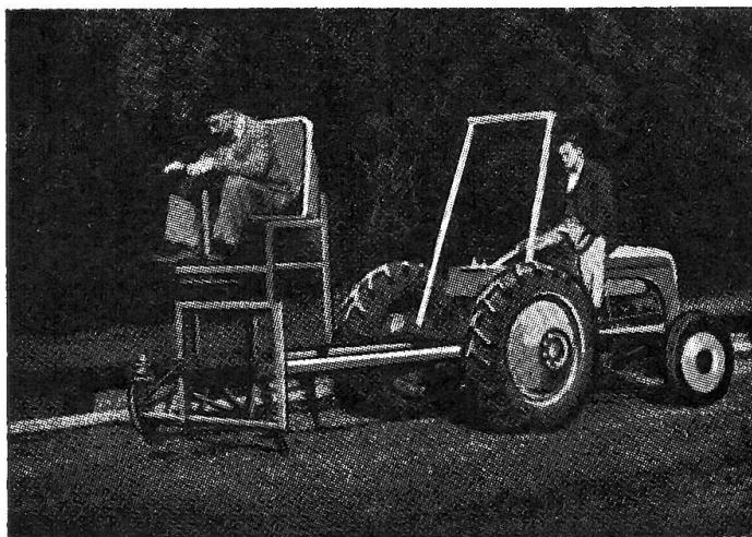
Châssis d'essai prévu pour étudier la position optimum du siège du conducteur par rapport aux pièces travailantes, et vice versa.
