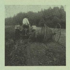
Fig. 37: Arracheuse-aligneuse portée pour la récolte des pommes de terre avec tambour cribleur tronconique.
