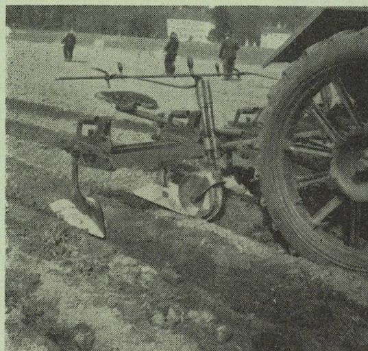
Fig. 32b: Corps butteurs utilisés avant le passage des étoiles à planter ainsi que pour recouvrir et butter haut.
