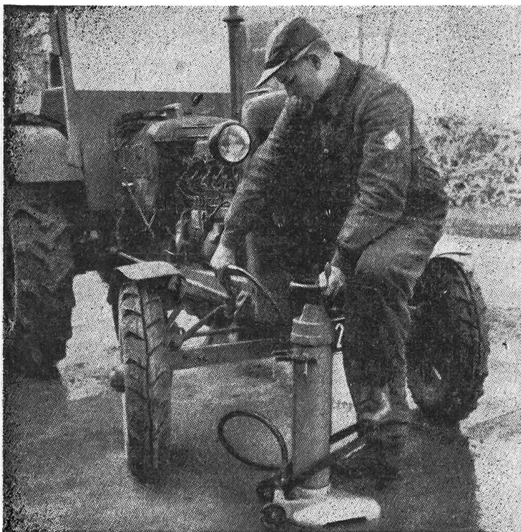
La lubrification au moyen de la presse à graisse à pédale (haute pression)
