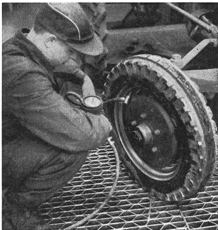
Le compresseur et le manomètre de contrôle permettent un gonflage rapide et une pression conforme aux prescriptions
