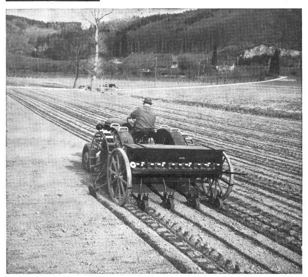
Le semoir AEBI se livre de plus en plus pour être adossé au tracteur de culture pourvu de la suspension hydraulique en 3 points. Au travail, le mécanisme de distribution est actionné par les roues du semoir, comme à l'ordinaire. Sur route, et pour tourner au bout du champ, on relève la machine avec l'hydraulique. Le dispositif de suspension peut être complété par des marqueurs de ligne et des ameublisseurs de voie. Cet équipement s'adapte aussi aux semoirs AEBI existants.
