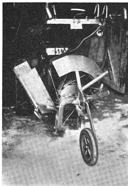
Fig. 2: La trémie d'alimentation est montée sur le côté
