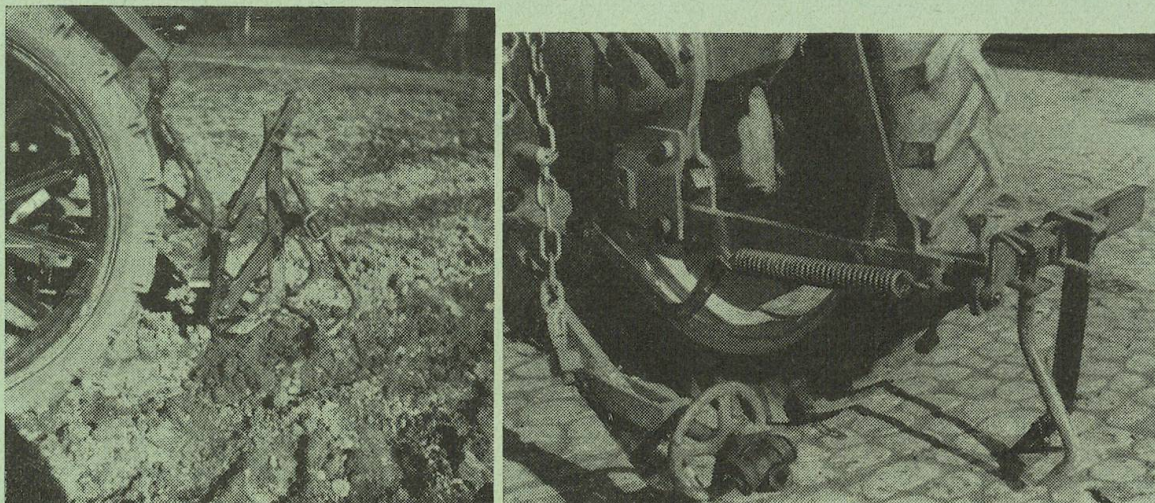
Fig. 3a: Effaceur de traces formé de trois griffes ameublisseuses et qui est assujéti à la barre d'attelage par un dispositif de fortune.
