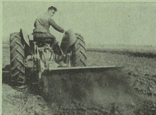
Fig. 23a et 23b: Herse rotatives entraînées par la prise de force arrière. — A droite: par suite de la largeur restreinte (adaptation à la puissance du moteur), le Rotavator n'atteint pas la trace de l'autre roue. En l'utilisant, il faut donc commencer à travailler au milieu du champ et tourner ensuite en rond.
