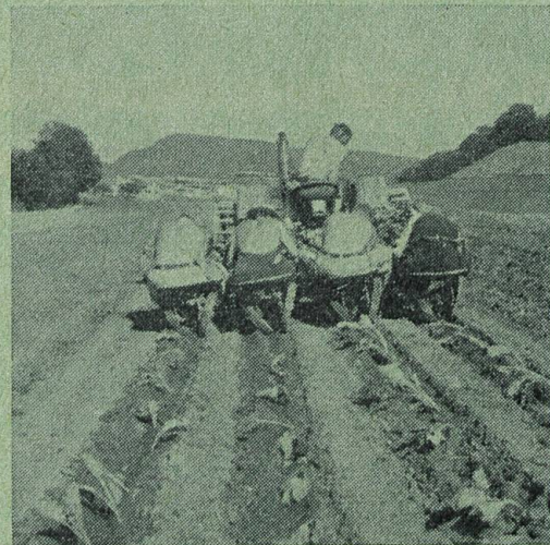
Fig. 4d: Travaux de repiquage effectués avec des éléments planteurs-repiqueurs semi-automatiques sur un sol émietté au rouleau (inclinaison du terrain: 15 %).
