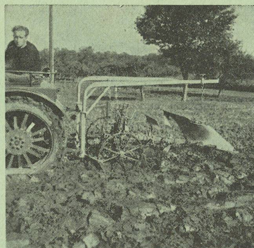
Fig. 18: Charrue brabant montée au dispositif de relevage hydraulique (un seul homme de service).
