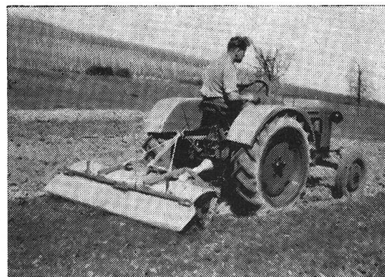
Fig. 11: Le tracteur Alpina-Oekonom à structure haute, équipé d'un moteur Diesel Hatz. Charrue Brabant Knecht portée par le dispositif d'attelage en trois points.
