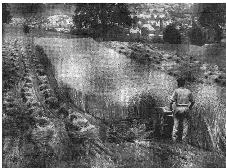
Fig. 4: Le même dispositif de liage que sur la fig. 3, également monté sur un tracteur Rapid à un essieu, vu au travail.
