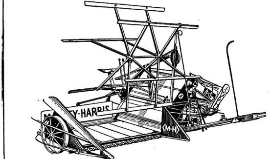
**LIEUSE COMBINÉE**, prise directe à tracteur ou traction animale alternativement possibles. Construction robuste. Mécanismes montés sur roulements à billes ou coussinets à rouleaux de précision. Largeur de coupe 150 cm ou 180 cm.
