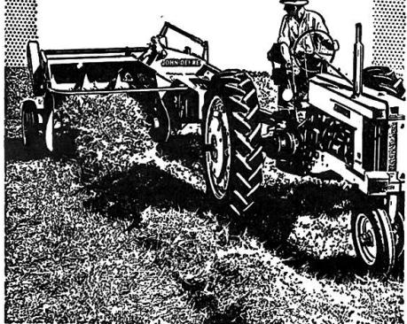
Presse-ramasseuse pour pressage à faible ou à haute densité. Liage double par ficelle. Livrable pour commande par prise de force ou par moteur auxiliaire.
