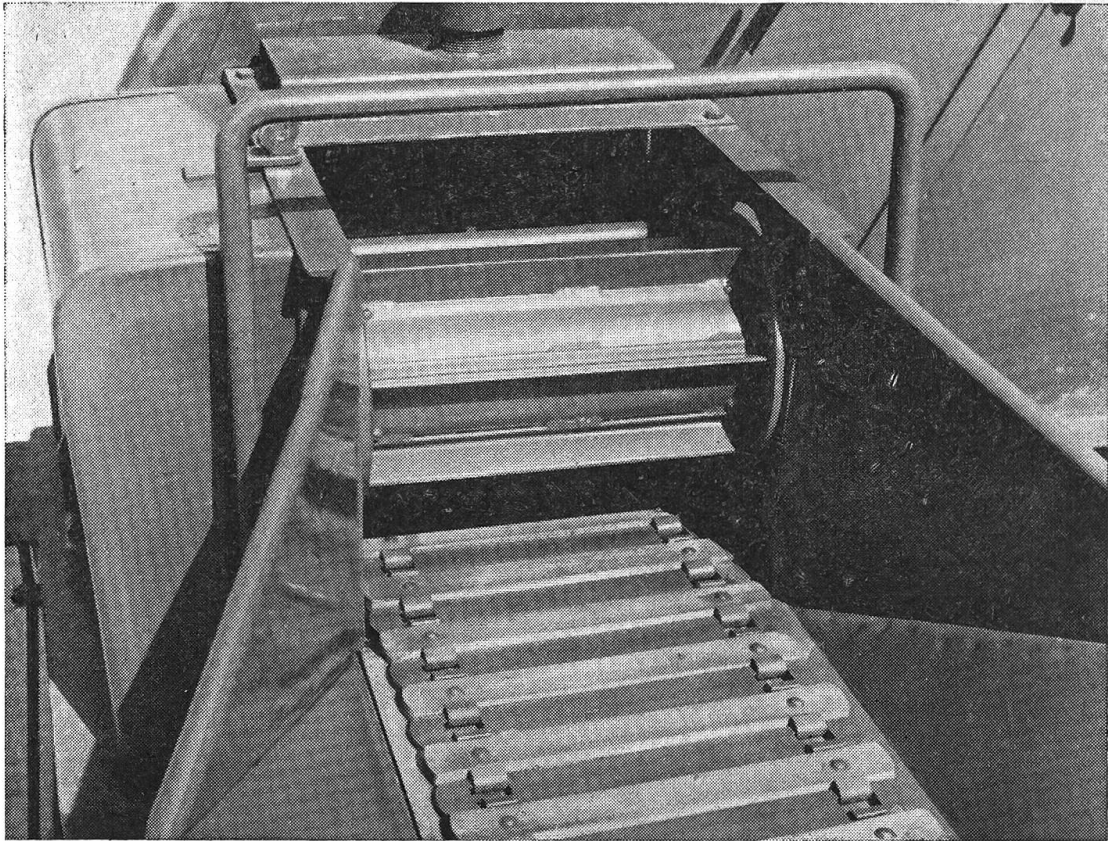
Fig. 8: Le rouleau de compression de la hacheuse-chargeuse à fourrages «Bucher-Guyer». Il est particulièrement apprécié lors du hachage des fanes de betteraves sucrières.
