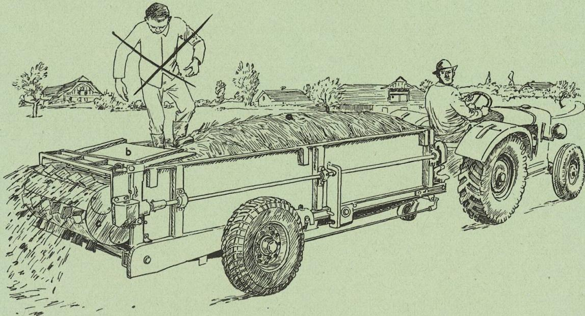
Premièrement le véhicule a été trop chargé (a). Aussi le fumier s'accumule-t-il devant le couvercle (b) lors de l'alimentation du tambour d'épandage et il se trouve bientôt un espace vide sous ce dernier. L'aide essaye maintenant de débouler la machine pendant la marche. La planche (b) couvre l'arbre dont la vitesse de rotation est élevée (c) et qui représente un danger caché !
