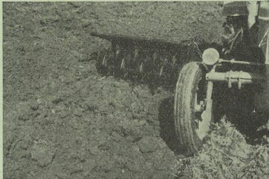
faites ont montré que des tracteurs d'une puissance effective d'environ 25 CV (au frein), et dans le cas de conditions du sol pas trop défavorables, ne parviennent plus à satisfaire au besoin de force motrice d'une herse dont la largeur de travail dépasse 1,60 m.
